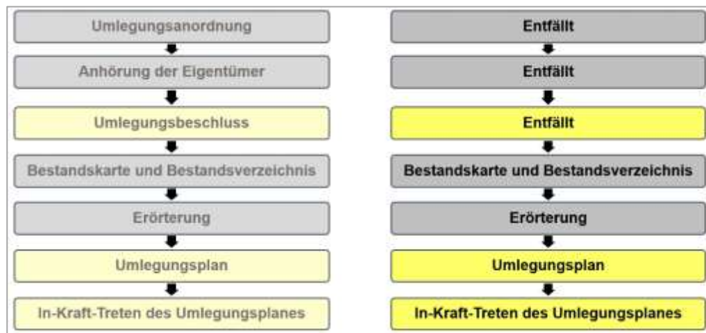
Abb. 4 Schematische Darstellung der Verfahrensschritte der Umlegung nach § 45 BauGB (links) im Vergleich zur vereinfachten Umlegung nach §§ 80 ff. BauGB (rechts)
