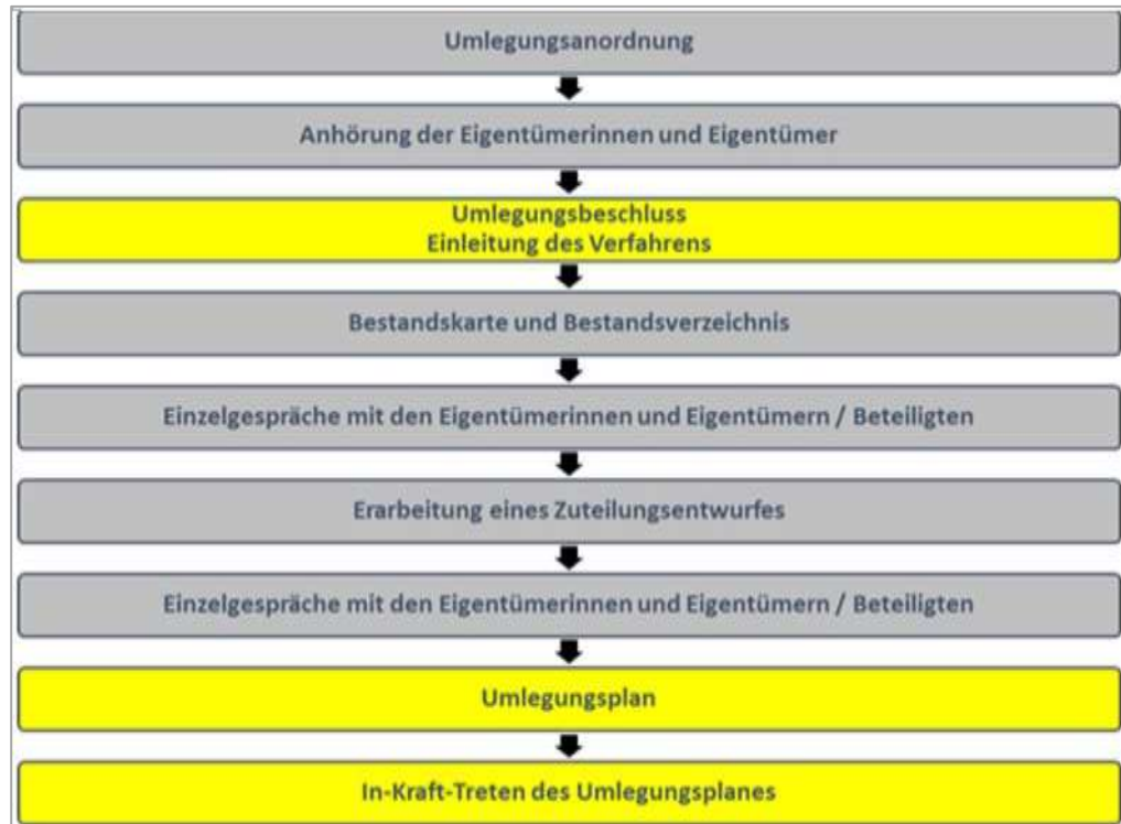
Abb. 3 Schematische Darstellung der Verfahrensschritte der Umlegung nach §§ 45 ff. BauGB
