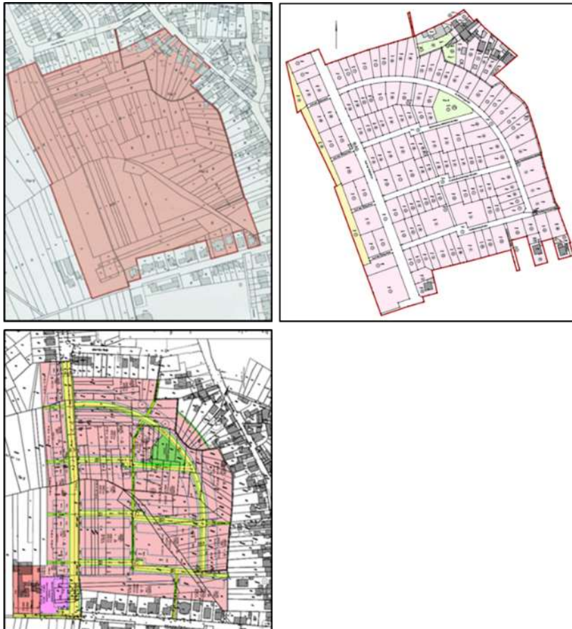
Abb. 1: Bodenordnungsbedarf infolge eines Bebauungsplans durch Umlegungsverfahren gelöst
